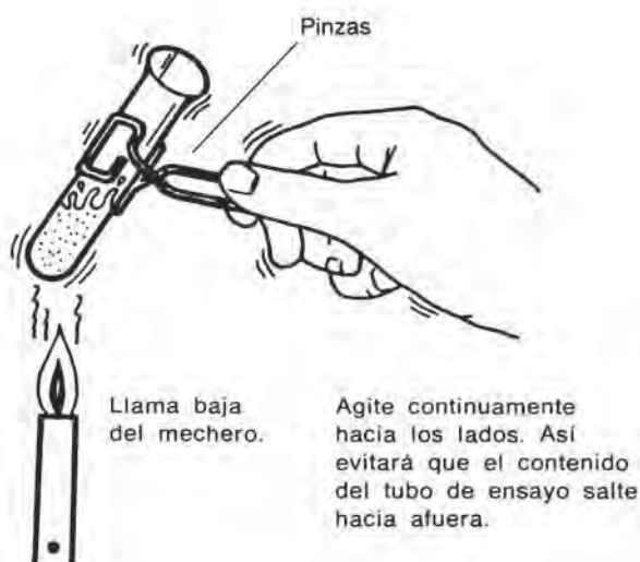
Fig. A.2. Cómo calentar el contenido de un tubo de ensayo.
