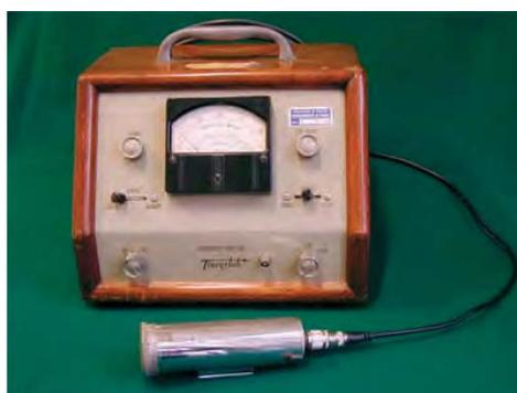
Fig. 11.6. Contador de radiactividad de Geiger-Müller.
