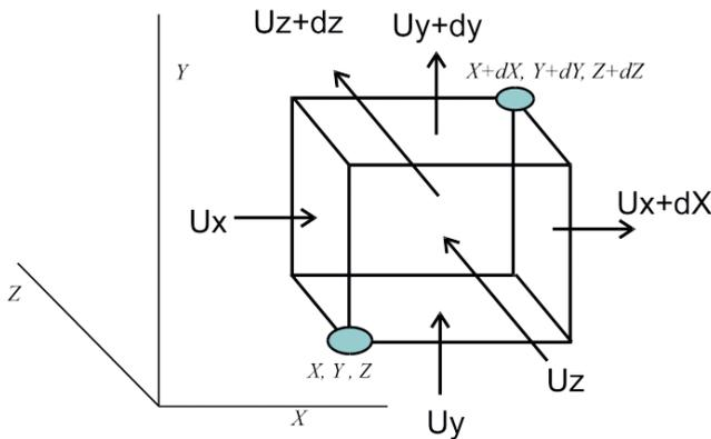
Figura 4.8. Elemento diferencial de volumen, coordenadas cartesianas, vector velocidad descompuesto en las tres coordenadas.
