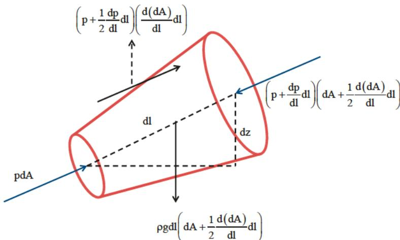
Figura 2.2. Balance de cantidad de movimiento en un tubo de corriente.
