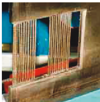
Banda reforzada con cables de acero
