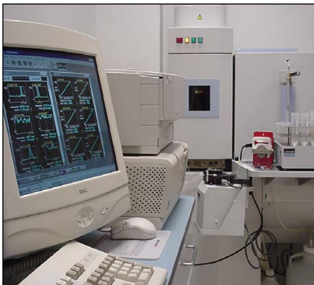
Espectrómetro de emisión atómica ICP-OES. Laboratorio de Medio Ambiente Guardia Civil
