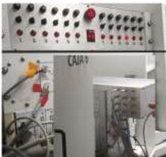
FUENTE DE ALIMENTACIÓN MÚLTIPLE PARA CAJAS DE SKINNER Profesor Emilio Ambrosio, Dpto. Psicobiología, UNED)
